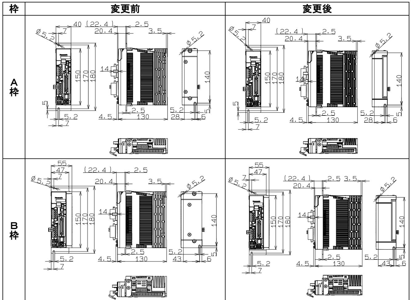
この仕様変更によるACサーボアンプの特性や性能、外形寸法図に記載の箇所の寸法に変更はございません。
