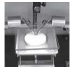
Tracking resistance test 耐トラッキング試験
