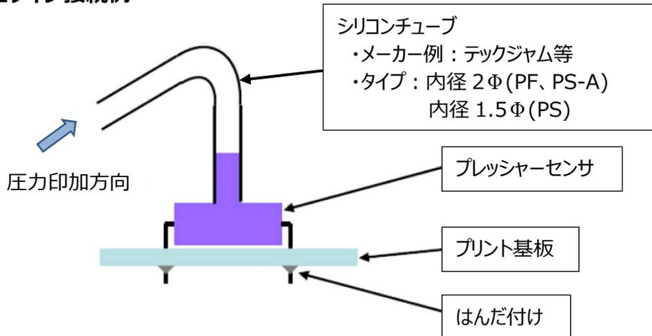
Fig.2 高圧タイプ接続例
