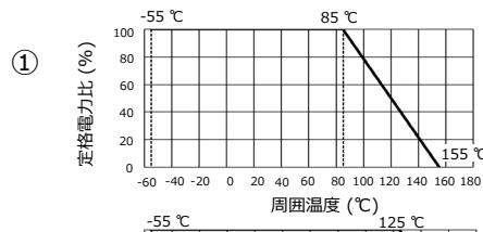
② 定格端子部温度以上で使用されるときは、右図負荷軽減曲線にしたがって定格電力を軽減してください。また、製品温度がカテゴリ上限温度以下になる条件でご使用ください。
