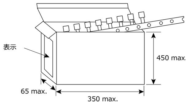
コンデンサ寸法、テーピング形状、包装個数により、箱寸法がかわりますのでお問い合わせ願います。
