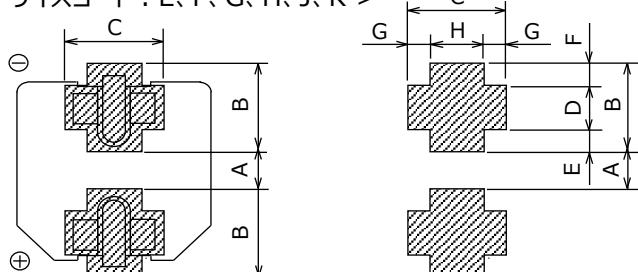
\* 貴社設計基準に基づき、実装性、はんだ付け性、取付け強度等を考慮し決定してください。
