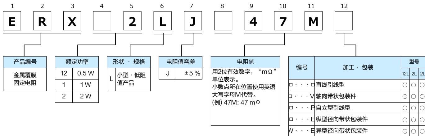
上例所示为额定功率2 W 的小型金属覆膜固定电阻，其电阻值为 47  $\text{m}\Omega$ ，电阻值容差为 ± 5 %。
