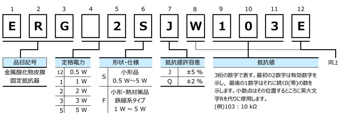
上記の例2は、定格電力が2 Wの小形金属酸化物皮膜固定抵抗器で、抵抗値が10 kΩ、抵抗値許容差が± 5 %、異形ラジアルテーピングのものを示します。
