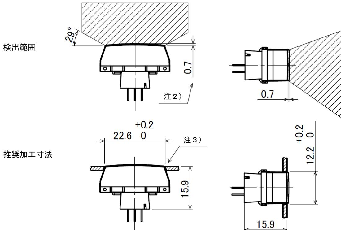
注1) 検知性能確保の為、レンズ先端より6.2mm以上は筐体から露出して取り付けて下さい。
