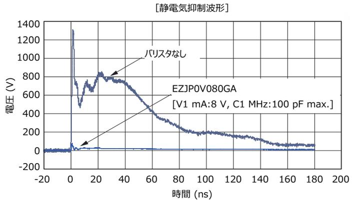
\*IEC61000-4-2 … 人体から発生する静電気放電を想定した静電気試験法 (HBM) の国際規格で、4 段階の厳しさレベルが設定されている。
