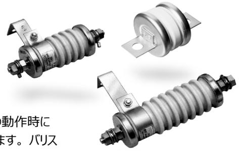
電力送受電設備のGIS化、高圧真空遮断器の普及にともない、これらの機器の動作時に極めて急しゅんなサージが発生し、高圧機器や電力ケーブルの絶縁を脅かしています。バリスタ(ZNR®サージアブソーバ)は、従来のギャップレス避雷器と異なり、酸化亜鉛セラミックスを用いたギャップレス避雷器であり、動作特性に遅れない優れた保護効果があります。しかも小形で高信頼性のため高圧モータ、トランス、高圧整流器、電力ケーブル防蝕層などの保護に採用されているほか、一般の高圧機器の負荷側サージ吸収器としても、広く使用されています。
