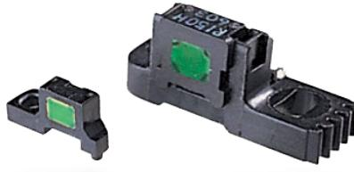
使用磁性薄膜抗磁元件的 FG (频率发生) 传感器。是一种可检测出 0.1 mm ~ 1.0 mm 精细起磁转动的磁性传感器。
