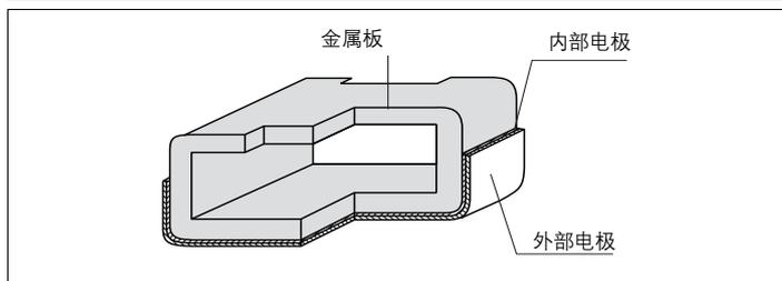
EYF3CU的电极 内部电极、外部电极 外圈
